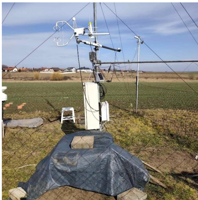
3. ábra: A kihelyezett ammóniamérő és meteorológia mérésekhez szükséges eszközök összessége
